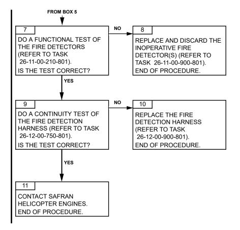
Failures observed during engine operation71-00-06-814-842-A01Page 103Apr. 15/2020Apr. 15/2020
