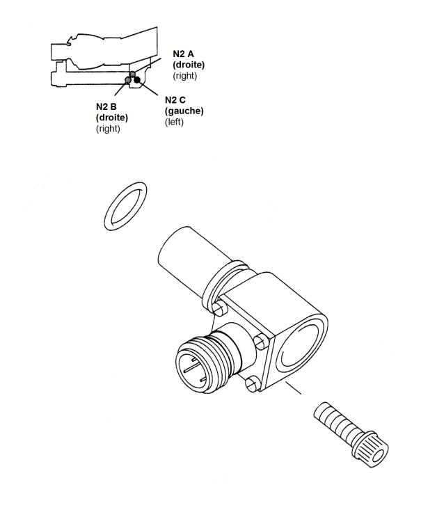
Capteurs de vitesse N2 N2 speed sensors
